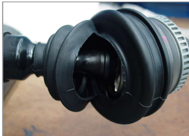
Рис. 2 – Трещины в пыльнике из-за неправильного размещения пыльника на полуоси
