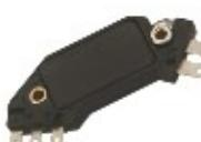
Функция модулей зажигания заключается в контроле и синхронизации искрообразования при работе двигателя. В ассортименте Mobiletron более 160 видов модулей зажигания, которые по-прежнему активно используются во многих видах транспортных средств.
