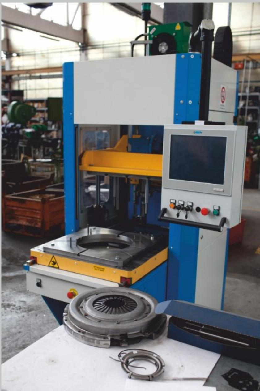
Станок для сборки корзин сцепления
