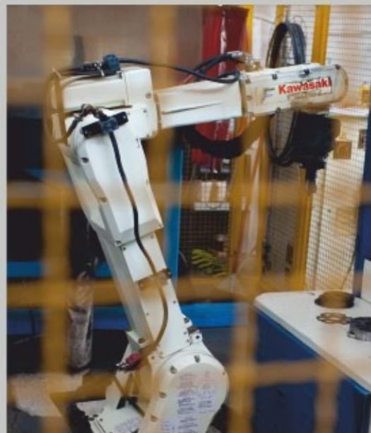
Подобные этому агрегаты используются автопроизводителями при сварке кузовов и других элементов.
