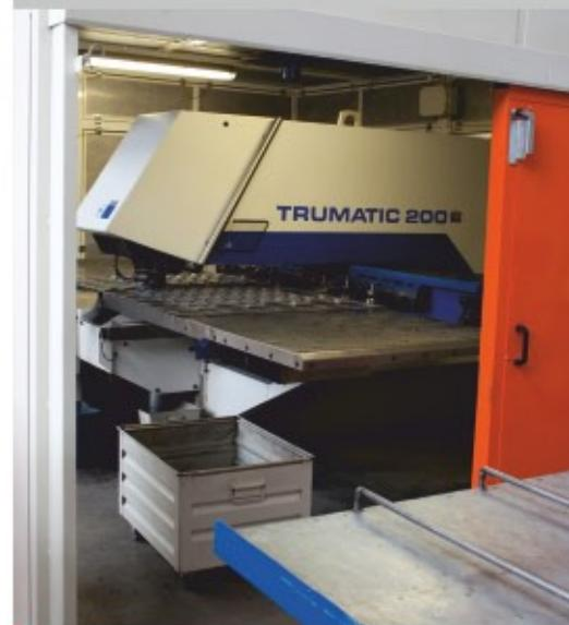
Автоматический штамповочный станок. На нем изготавливаются плоские металлические заготовки для демпферов дисков сцепления. Станок работает без участия рабочего персонала, а во время его работы, при появлении человека в зоне близости, штамповка автоматически прекращается. Безопасность работников прежде всего!
