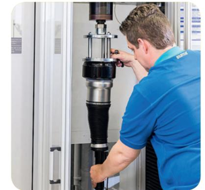
Тестирование пневмомодулей на стенде
