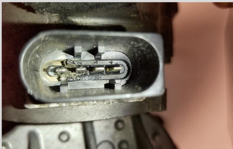
Нарушение работы электроники вследствие плохой герметизации и конденсата
